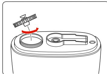
2. Stürzen Sie den Wassertank und öffnen Sie den Tankdeckel, indem Sie diesen nach links drehen.
