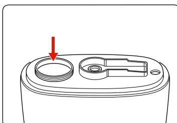
2. Retourner le réservoir d'eau et ouvrir le bouchon du réservoir, en le tournant vers la gauche.
